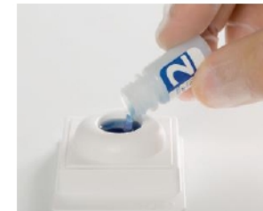
Homogénéiser par inversion le flacon 2 puis vider son contenu dans la cupule et attendre que le liquide ait traversé la membrane
