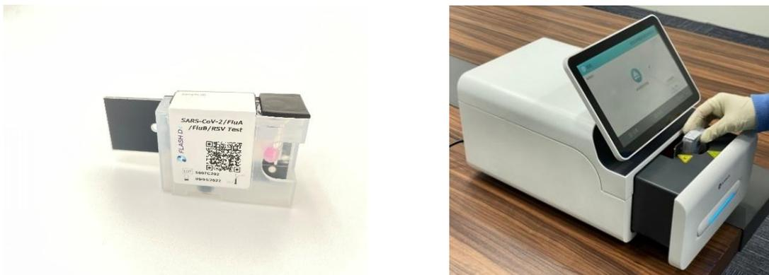
**Image 3.** Gauche : une fois entièrement refermé, le couvercle du port d'échantillonnage se trouve au même niveau que le reste de la partie supérieure de la cartouche.
