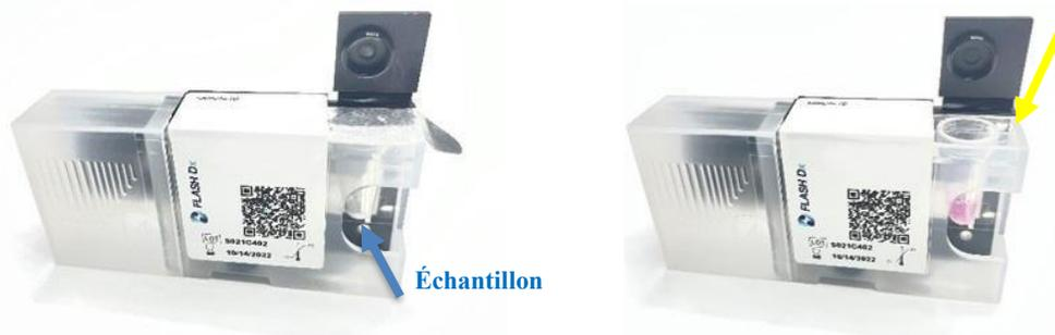
**Image 1.** Gauche : cartouche ouverte présentant la pastille lyophilisée blanche au fond de la chambre d'échantillon ; Droite : assurez-vous qu'il ne reste pas d'aluminium sur le dessus de la chambre à échantillon.
