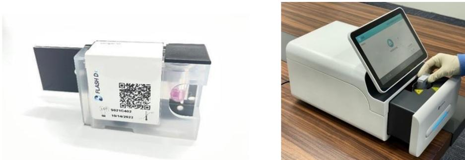
**Image 3.** Gauche : une fois entièrement refermé, le couvercle du port d'échantillonnage se trouve au même niveau que le reste de la partie supérieure de la cartouche. Droite : insérez la cartouche dans le quai de chargement de l'instrument.
